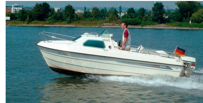
Das Clubboot ist eine Ryds 535 FC, 5,35 x 2,15 m (Länge x Breite) mit 50 PS Honda Viertakt-Außenbordmotor, kleiner Kajüte, 60-Liter-Benzintank, Bootszubehör wie Fender, Leinen, Bootshaken, Anker, Rettungswesten etc. Das Boot wird auf einem 1300 kg Harbeck-Trailer mit Sliphilfen transportiert.
